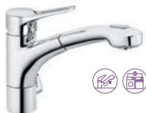
399450562 Spültisch-Multi-Einhandmischer DN 8 schwenkbarer Auslauf herausziehbare Geschirrbrause mit Umstellung Brause/Strahl Anschluss für Wasch-/Spülmaschine H1 220, H2 153, A 225, Ø1 34, Ø2 58
