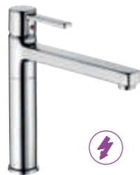
38979..75 Spültisch-Einhandmischer DN 10 schwenkbarer Auslauf Für drucklose Speicher H1 228, H2 155, A 195, Ø1 34, Ø2 45
