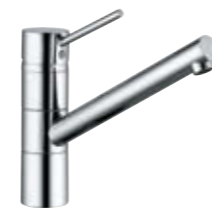
33930..75 Spültisch-Einhandmischer XL DN 10 Auslauf um 360° schwenkbar H1 192, H2 145, A 200, Ø1 32, Ø2 45
