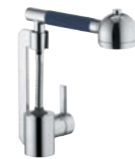
42101Z175 Spültisch-Einhandmischer DN 10 vertikal herausnehmbare Handbrause mit Umstellung Brause/Strahl H1 272, H2 211, A 176, Ø1 34, Ø2 52
