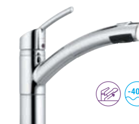
33981..75 Spültisch-Einhandmischer DN 8 herausziehbare Geschirrbrause mit Umstellung Brause/Strahl schwenkbarer Auslauf H1 230, H2 155, A 226, Ø1 34, Ø2 52
