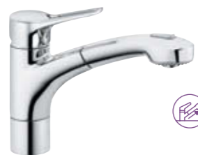
399410562 Spültisch-Einhandmischer DN 8 schwenkbarer Auslauf herausziehbare Geschirrbrause mit Umstellung Brause/Strahl H1 220, H2 153, A 210, Ø1 34, Ø2 58 399420562 Für drucklose Speicher*
