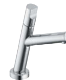
579040575 Spültisch-Einhandmischer DN 10 schwenkbarer Auslauf mit Wasserstopp H1 250, H2 168, A 200, Ø1 35, Ø2 65
