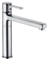
38973..75 Spültisch-Einhandmischer DN 10 schwenkbarer Auslauf H1 228, H2 155, A 195, Ø1 34, Ø2 45
